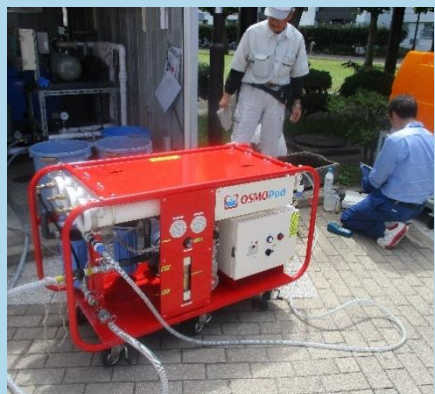
発電機(写真左)や浄化装置(写真右)を毎月動かして、常に作動するようにメンテナンスしています。
